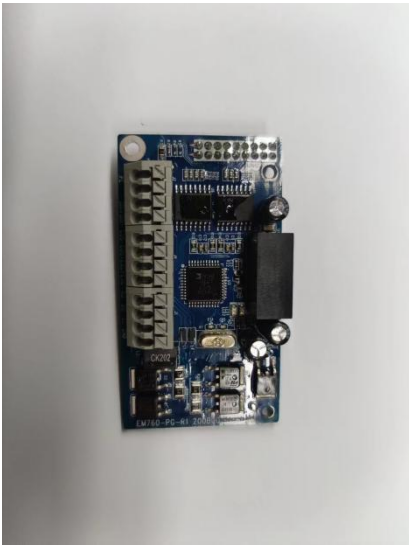
图 9-20 旋变 PG 卡实物图
