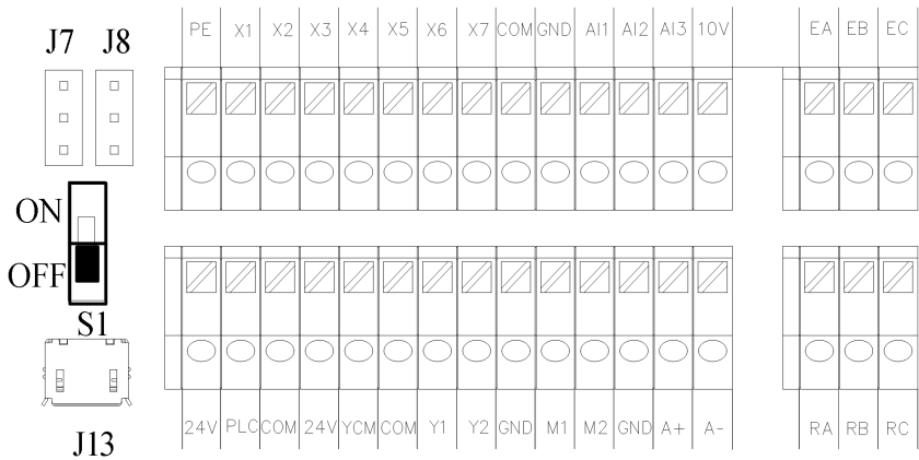
图 3-16 控制回路端子排列
