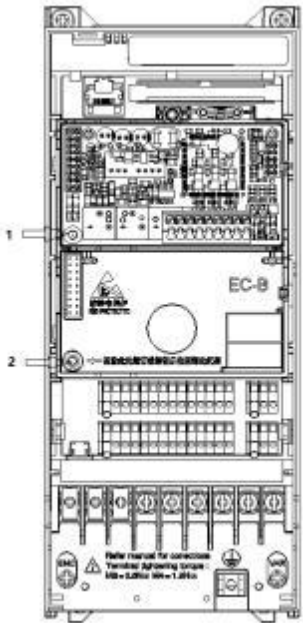
图 9-21 PG 卡安装示意图
