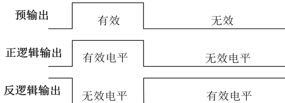
图 7- 14 数字输出端子正反逻辑输出示意图
