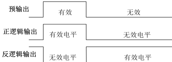
图 7- 14 数字输出端子正反逻辑输出示意图
