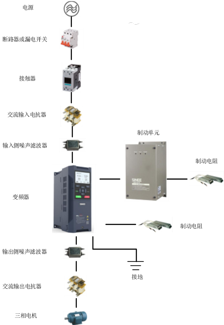
图 3-1 变频器与外围设备的连接图
