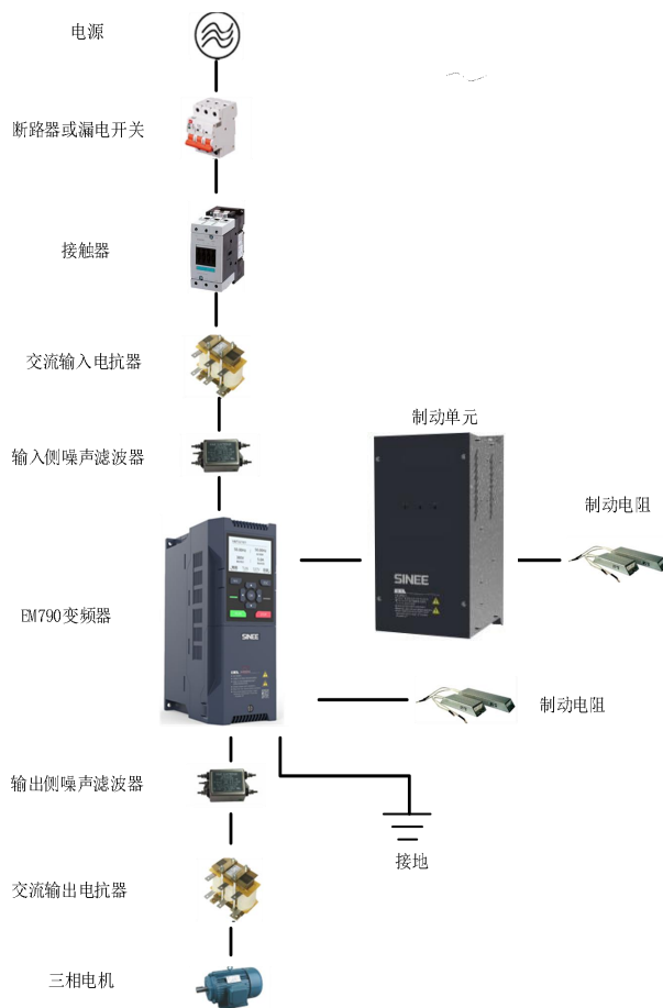
图 3-1 变频器与外围设备的连接图
