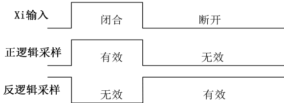
图 6-18 端子正反逻辑采样示意图
