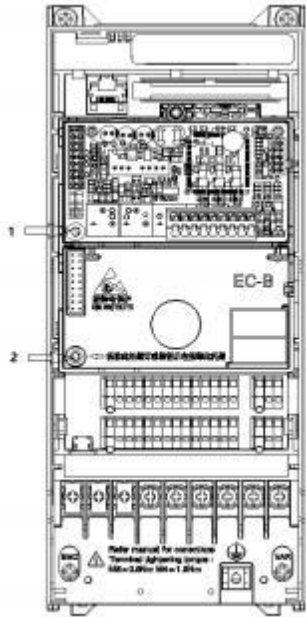
图 9-10 PG 卡安装示意图
