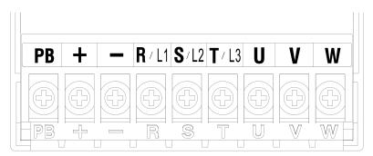
a) Schematic Diagram of Terminals (EM730-0R7-3B~EM730-1R5-3B)
